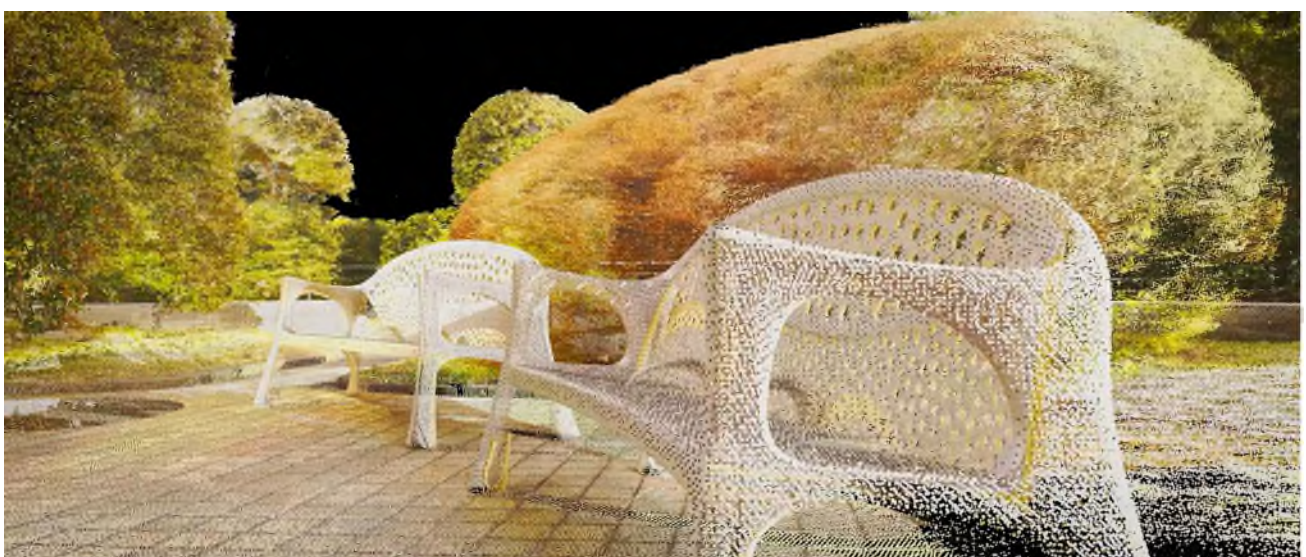
大阪ガスビルディング屋上の 3 次元点群データを拡大(点の集合で立体が表現されている)
